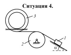
Масса груза I равна  $m_1$ ; он скользит по гладкой плоскости. Массой колеса 2 пренебречь. Двойное колесо 3 массы  $m_3$  катится без проскальзывания по шероховатой плоскости; его радиусы равны, соответственно  $R_3$  и  $r_3$ ; радиус инерции равен  $\rho$ . Найти ускорение  $a_1$  груза I.
