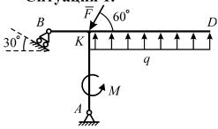
Невесомая рама ABKD находится в равновесии под действием силы  $\overline{F}$ , пары сил с моментом M и равномерно распределённой нагрузки с плотностью q. Длины BK = L, AK = 2L, KD = 3L. Найти реакцию  $N_B$  опоры B.
